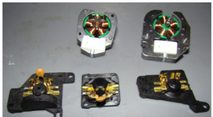
*Typische Teile wie 5-pol-Anker, Permanentmagnete und Motorschilde zu den gängigen drei Märklin-Motortypen für H0-Fahrzeuge*
