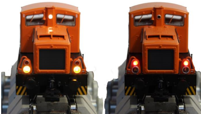
Die Beleuchtung der BR 101 bei Vorwärts- und Rückwärtsfahrt
