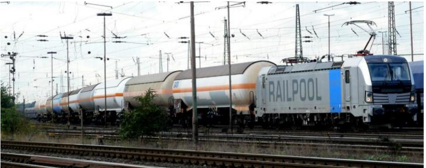
*Siemens Vectron BR 193 in der E-Lok-Ausführung vor einem Ganzzug mit Kesselwagen (Foto: Udo Brossmann)*
