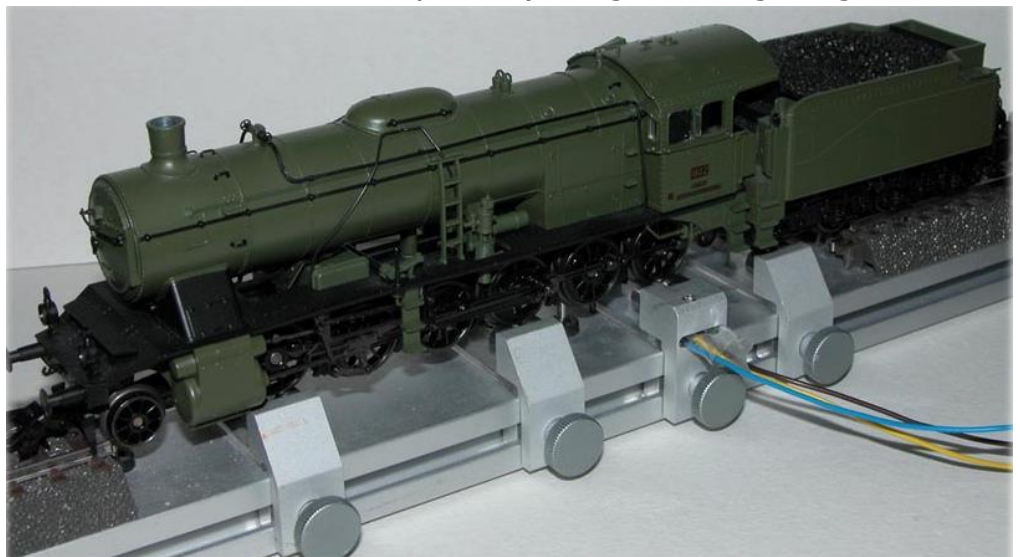
Der TachoMesser hier in Kombination mit dem Märklin-Rollenprüfstand (Foto: Thorsten Mumm)
