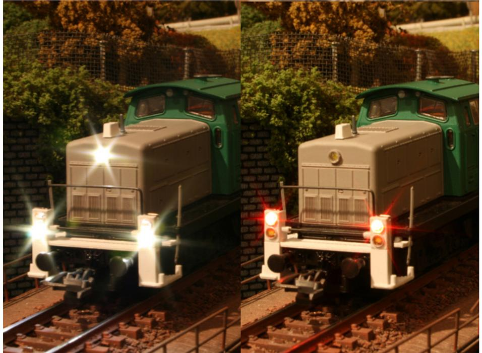
Sind alle SMD eingebaut und getestet, können die Handläufe wieder am Rahmen der Lok angebracht werden. Nun wird durch die vorhandenen Öffnungen der Kupferlackdraht ins Innere der Lok geführt. Wir haben uns dort auf einer kleinen Pertinax-Platte eine Art Platine für den Lichtanschluss mit den passenden Widerständen gefertigt.
