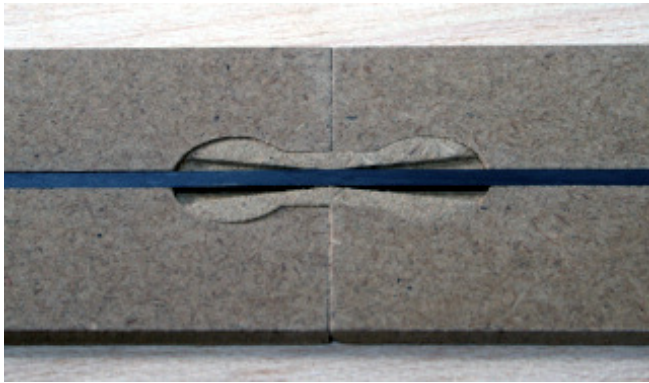
Das Magnetband lässt sich leicht in die ausgelaserte Nut eindrücken
