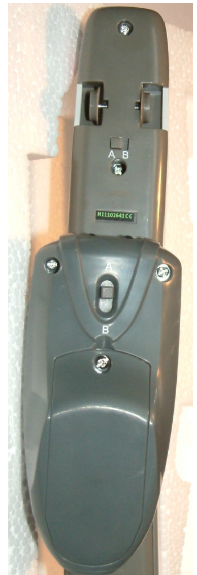
Die Umschaltung zwischen Frequenz A und B am Triebkopf und der Unterseite der IR-Fernbedienung
