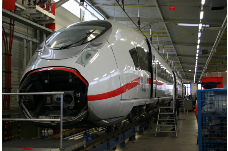
Montagearbeiten am ICE3-Nachfolger, dem Siemens „Velaro“
