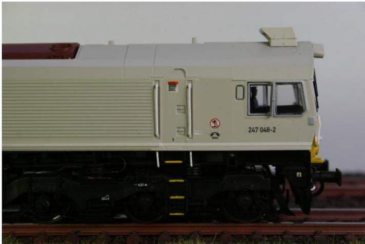
*In der Seitenansicht ist die Klimaanlage über dem Führerstand deutlich zu erkennen*
