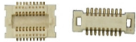
18-polige Buchse und passender Stecker der elektrischen Schnittstelle Next18
